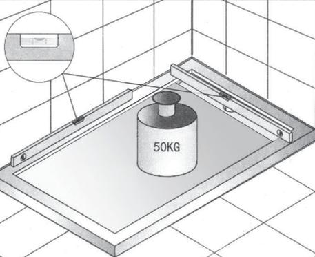
vaničku vyrovnajte do roviny pomocou vodováhy a nechajte odpočívať 24 hod.
