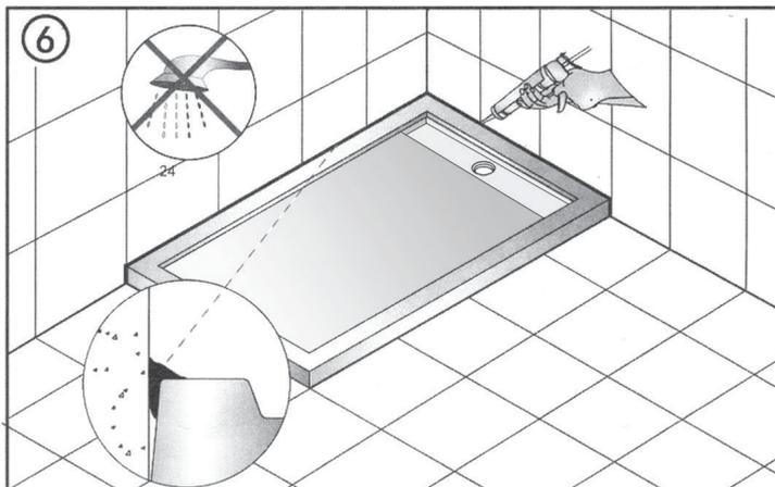
prosím vyplňte medzeri medzi stenou a vaničkou anti-plesňovým silikónovým tmelom a nepoužívajte sprchu/vodu po dobu 24 hod.
